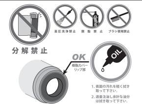
B.B.コンバーターシリーズは優れた防塵防水性能を 持っていますので、ベアリング内部はメンテナンス フリーにてご使用いただけます。
