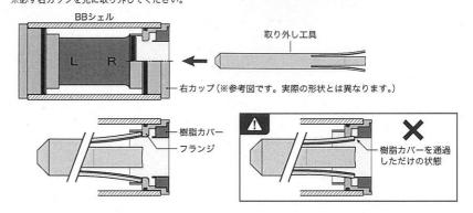
② 工具がフランジに引っ掛かっていることを確認し、工具の頭をハンマーなどで叩いて右カップを取り 外してください。
