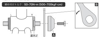
⑥ 左カップ(正ネジ)を工具 **B** で徐々に締め込んで玉当たりを調整してください。アクスルのガタつきが無くなり、回転が少しだけ重くなる程度が適切です。
