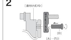
ベースプレート[A]一穴②にボルト[D]を挿入し [直付け式 FD]へ締め込み固定してください。
