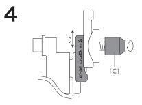
FD の取扱説明書に従い高さと角度を調整しナット[C]を締め込み固定してください。
