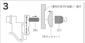
自転車フレームの[直付け式 FD 台座] ―長穴にボルト [B] の先端を挿入します。次に[Rワッシャー] を通してから、ナット[C]を取り付けてください。
