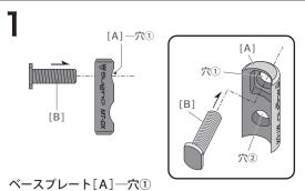
ベースプレート[A]一穴① にボルト[B]を挿入してください。
