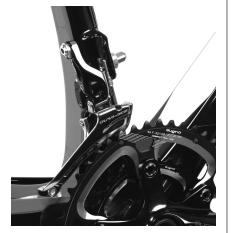
装着後、変速調整まで完了しましたら FD を作動させ 各部位に緩みがない事を確認してください。
