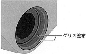
※ガスケットリングが磨耗または破損している場合は、ガスケットリングを交換してください。
