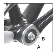
Tightening torque 30~50N·m (300~500kgf·cm)
